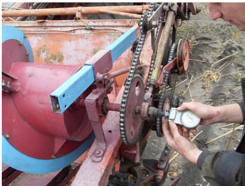
Рисунок 3.9 – Замер частоты вращения шнека-мотовила тахометром ИО-30
