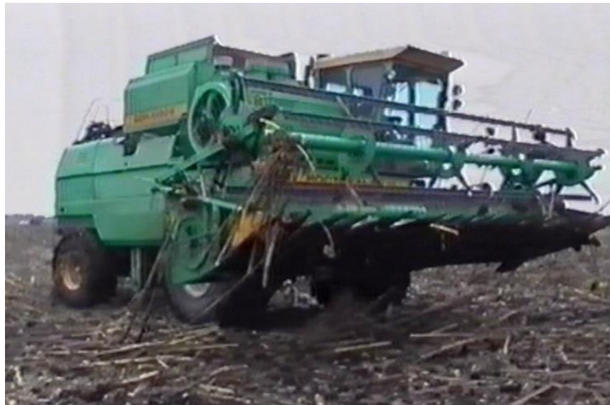
Рисунок 1.11 – Наматывание стеблей подсолнечника на рабочие элементы жатки
