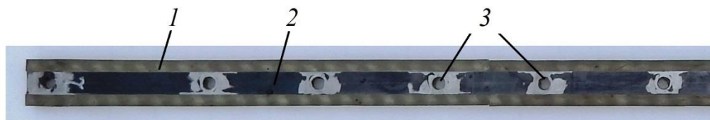
Рисунок 3.12 – Экспериментальный бич из полиуретана: 1 – бич; 2 – стальной сердечник; 3 – отверстия под болты
