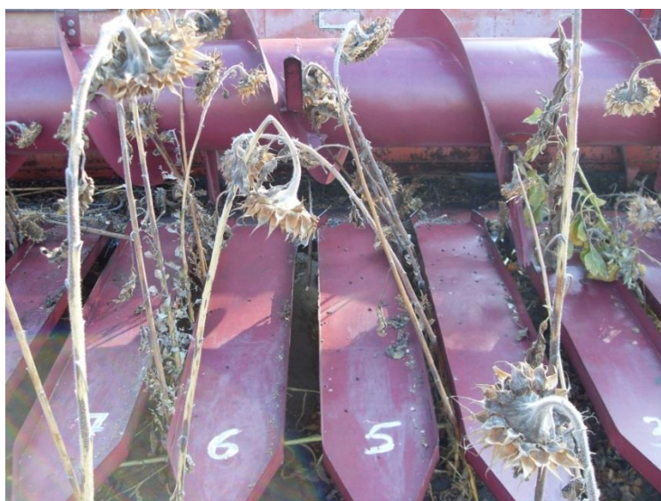
Рисунок 5.3 – Работа жатки со шнеком-мотовилом и стеблеподъемниками в полевых условиях
