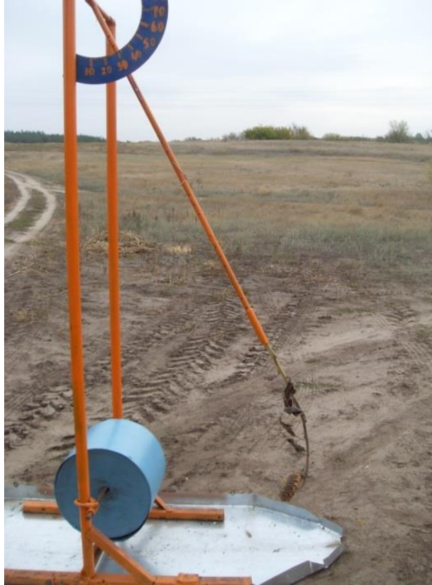
Рисунок 3.19 – Экспериментальная установка для исследования осыпаемости маслосемян из корзинок
