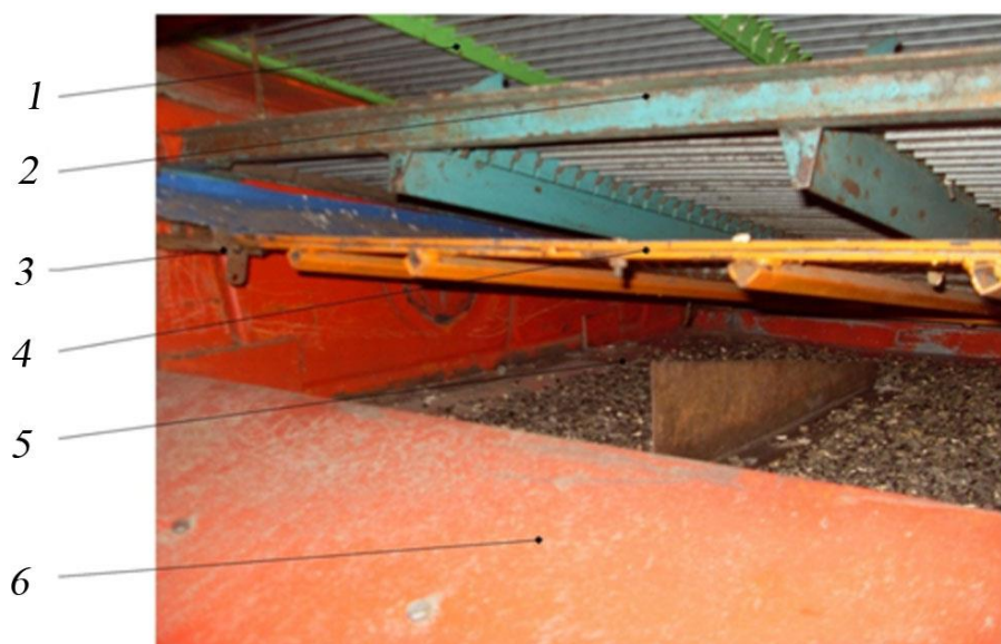
Рисунок 5.5 – Установка решета с регулируемыми отверстиями в систему очистки комбайна: 1 – верхнее решето; 2 – нижнее решето; 3 – кронштейн для крепления решета с регулируемыми отверстиями; 4 – решето с регулируемыми отверстиями; 5 – днище корпуса нижнего стана; 6 – направляющая воздушного фартука вентилятора
