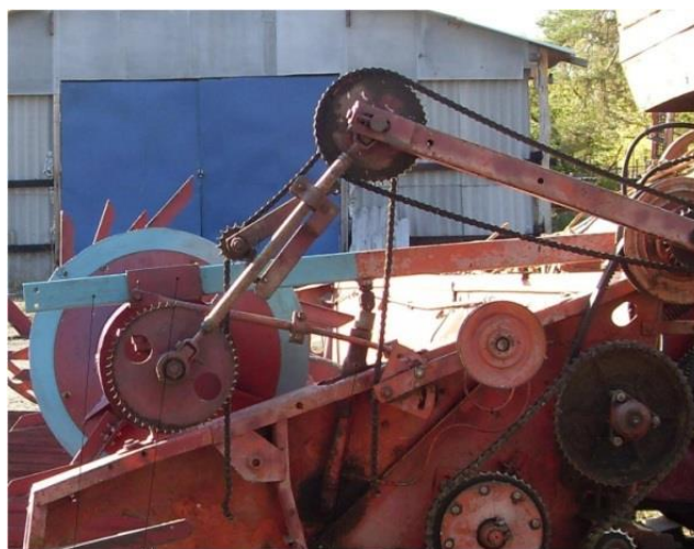
Рисунок 3.3 – Регулировка экспериментального мотовила по высоте и горизонтальному положению: 1 – гидроцилиндры подъема мотовила; 2 – поддержки; 3 – ползуны
