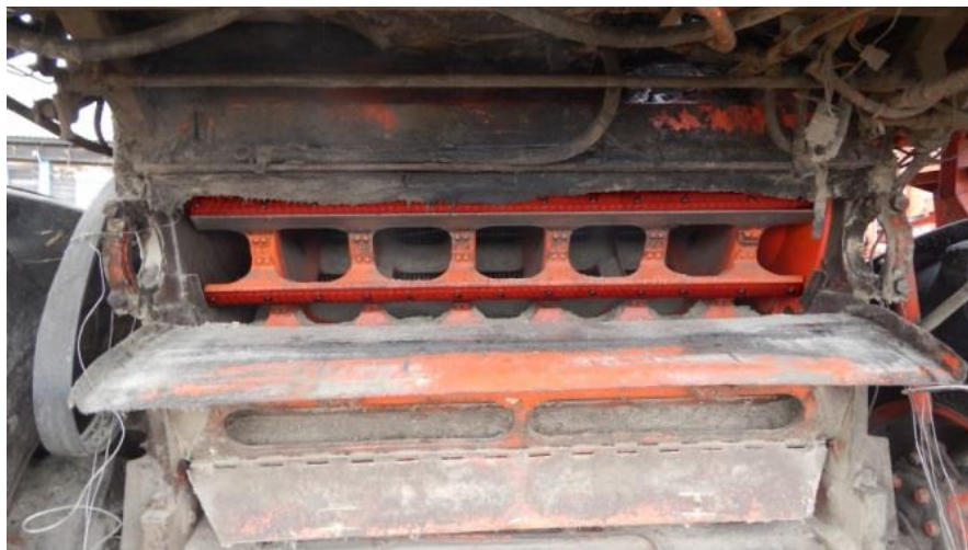
Рисунок 3.13 – Молотильный барабан ACROS 530 с экспериментальными бичами из полиуретана
