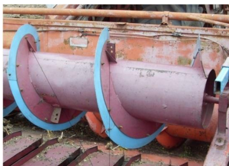
Рисунок 3.2 – Упоры, фиксирующие винтовую навивку относительно трубного вала
