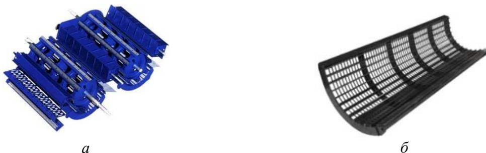
Рисунок 1.27 – Схема «приёмный битер, молотильный барабан, промежуточный битер, молотильный барабан, отбойный битер»: а – МСУ; б – подбарабанье с постоянным размером ячеек
