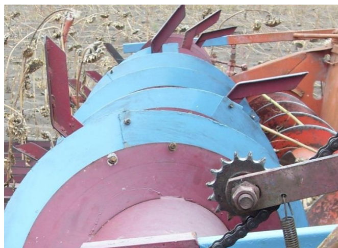
Рисунок 3.5 – Шнек-мотовило с установленными съёмными сегментами
