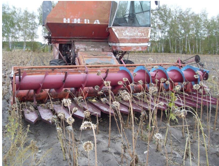
Рисунок 3.10 – Жатка с экспериментальным шнеком-мотовилом с Г-образным отсекателем и навивкой H_{\text{вит}} = 0,21 м
