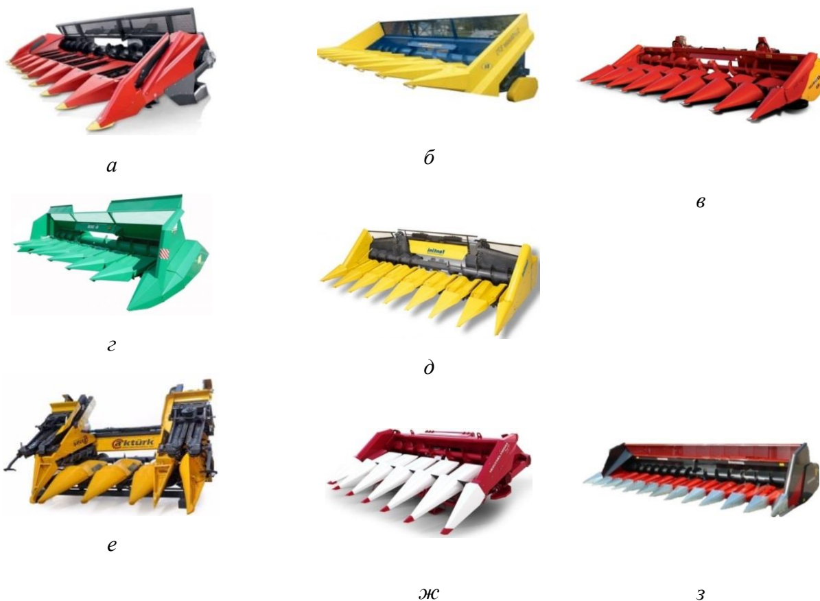
Рисунок 1.8 – Адаптеры с желобами: а – Geringhoff Sun Star Horizon; б – SunMaster; в – Quasar Capello; г – ПЗС-8; д – Fantini GP; е – Akturk Makina; ж – Argus R; з – Dominoni Top Sun
