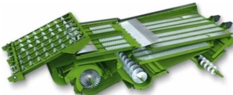
Рисунок 1.33 – ВРО с шнековыми транспортерами, дополнительной транспортной доской и передним верхним решетом
